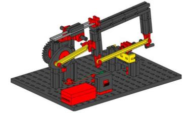
Bei dieser Getriebeart wird eine Drehbewegung in eine hin- und hergehende Bewegung umgewandelt. Die jeweiligen Endpunkte, an denen die Säge nicht mehr weiter kann, werden als Totpunkte (T1 und T2) bezeichnet.
