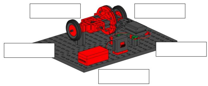
Beobachte und ermittle, wie sich Drehzahl, Drehrichtung und Drehmoment bei diesem Modell ändern, halte dazu zuerst abwechselnd das eine oder andere Abtriebsrad fest. Jetzt den Drehkörper (die Aufnahme der Mittelkegelräder) in der Mitte.
