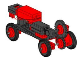
Damit das motorbetriebene Fahrzeug noch schneller fährt, baue Fahrzeug 2 (Bauanleitung S.16-17) nach. Dein Mobil fährt nun ...... mal so schnell wie sei Vorgänger. Dafür hat diese Übersetzung ihre Probleme am Berg.
