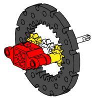
Das Planetengetriebe besteht im einfachsten Fall aus Sonnenrad (schwarzweiß), Planetenrädern (gelb), Planetenradträger (rot) und Hohlrad (schwarz). Bei diesem einfachen Planetenradsatz ist ein Sonnenrad in der Mitte über mehrere Planetenräder mit einem innenverzahnten Hohlrad formschlüssig verbunden. Sonnenrad, Planetenradträger oder Hohlrad können jeweils antreiben, angetrieben werden oder festgebremst sein. Um dein Getriebe so richtig auszuprobieren hast du an deinem Getriebe den Schieber.
