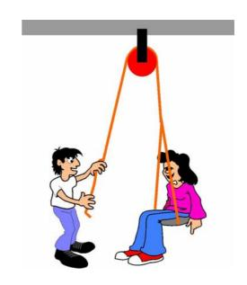
Ein Flaschenzug ist eine einfache Vorrichtung, mit der man schwere Lasten leichter hochheben kann.
