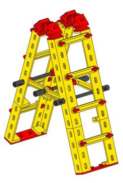
Einen sehr einfachen statischen Aufbau hat auch die Bockleiter. Diese Leiter verwendet auch die abgewinkelten Beinen, die verstrebt sind. Die Verstrebungen zwischen den Beinen dienen gleichzeitig Leitersprossen. Die Bockleiter besteht also aus zwei einzelnen Leitern die oben miteinander in einem Drehpunkt verbunden sind. Dazu kommt noch eine Verspannung der beiden Leitern im unteren Teil der Bockleiter.
