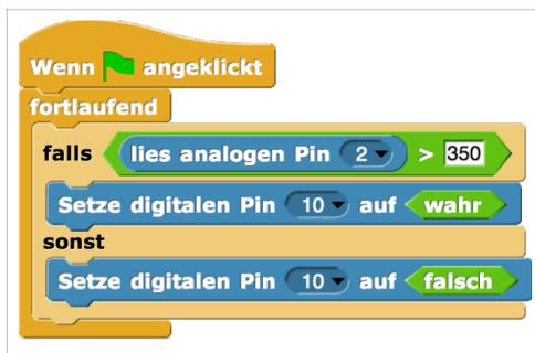
Im Schleifen-Block werden dem digitalen Ausgang 10 in Abhängigkeit von den am analogen Eingang A2 eingelesenen Werten die Werte **wahr** und **falsch** zugewiesen. Ist also der aktuelle Sensorwert an A2 höher als 350, wird die LED angeschaltet. Sonst (also wenn der Sensorwert kleiner oder gleich 350 ist) wird die LED ausgeschaltet.
