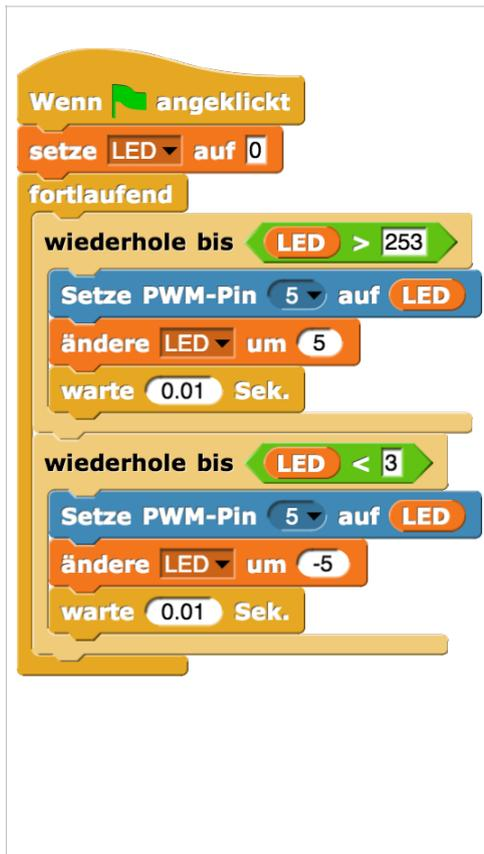
Für dieses kurze Programm wird die Variable „LED“ benötigt, in welcher der aktuelle Helligkeitswert der LED gespeichert wird. Die Variable wird durch Klick auf den Button „Neue Variable“ innerhalb der Kategorie „Variablen“ erzeugt.
