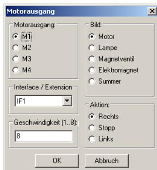
Für unseren Programmlaufplan benötigen wir den Befehl **Motor M1 links mit Geschwindigkeit 8**.
