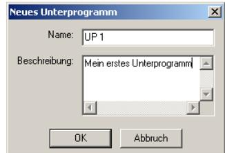
Du kannst jederzeit zwischen Hauptprogramm und Unterprogramm wechseln, indem Du in der Unterprogrammleiste auf den Programmnamen klickst. Da beide Programme noch leer sind, sieht man allerdings noch keinen Unterschied.
