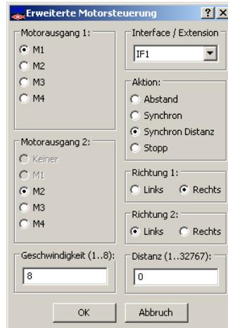
Wenn du eine Distanz vorgegeben hast, **wartet das Element nicht**, bis die vorgegebene Distanz erreicht ist, sondern geht sofort zum nächsten Programmelement über. Auf diese Weise kann das Programm weiter arbeiten und die Motoren bei bestimmten Ereignissen stoppen. Um zu testen, ob der Motor sein Ziel erreicht hat, gibt es für jeden Motor einen internen Eingang **M1E** bis **M4E**, den du mit dem Verzweigungselement oder dem **Warten auf Eingang** Element abfragen kannst.
