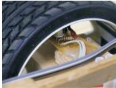
Abbildung 6.15: optischer Radencoder (Photoreflektor)
