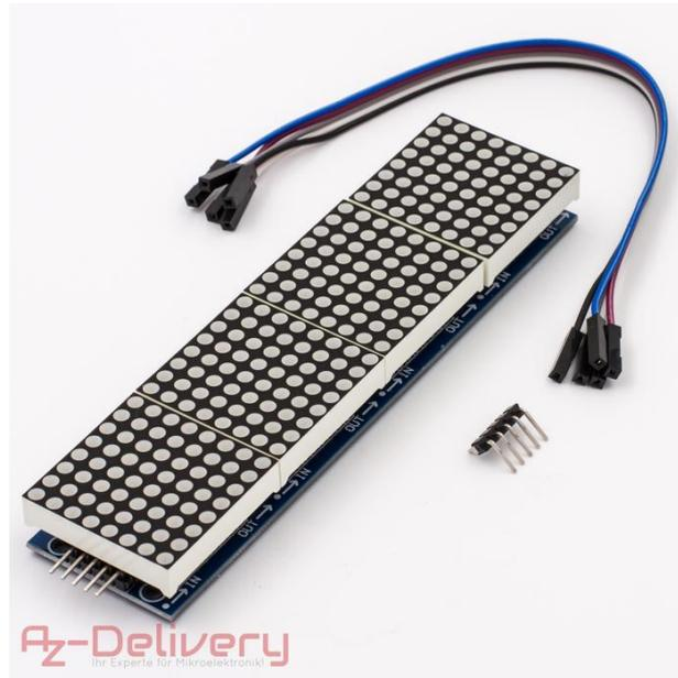
Die 4 x 64 LEDs in 8x8 Matrixschaltung lassen sich durch ein einziges Datenkabel ansteuern. Jede einzelne LED mit 3mm Durchmesser lässt sich einzeln steuern.
