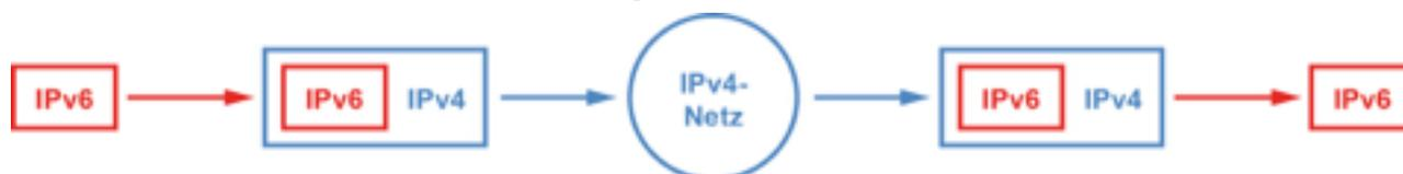
Die Grundidee von IPv6 ist, dass es über alle Übertragungssysteme funktioniert. Beispielsweise auch über IPv4. In der Regel sind zwei Router die Endstellen für den Tunnel. Der eigene Netzzugangsrouten und das IPv6-Gateway oder -Relay des Tunnel-Providers. Doch auch Clients können eigene Tunnelverbindungen aufbauen.
